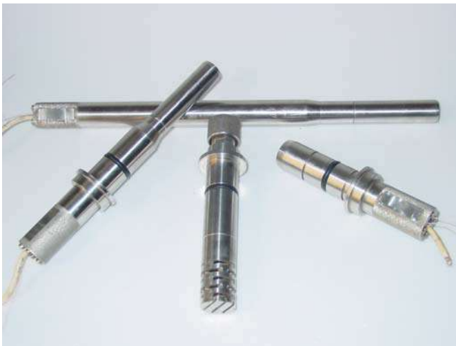
Рис. 3.6. Внешний вид стерилизуемых амперометрических сенсоров АСрО 2 -06.
